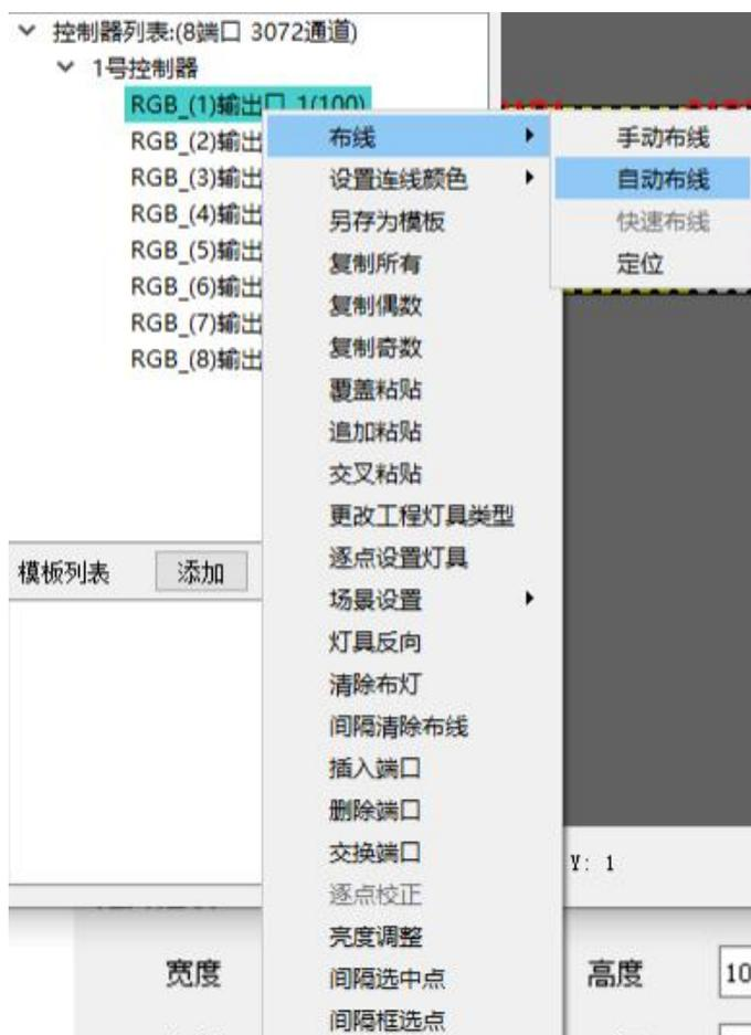
右键点击控制器输出口，选择右键菜单中“布线”选项中的“自动布线”选项，即弹出自动布线设置窗口，如下图所示：
