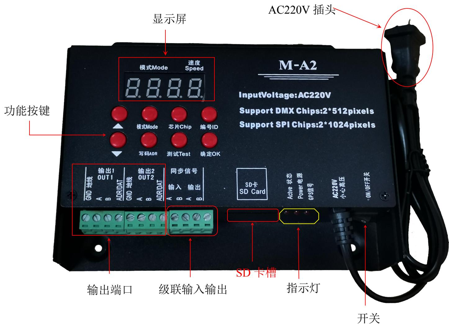
**注：**控制器为级联同步控制器，所以在实际应用多台同步时需要用线连接，具体连接方式见（级联示意图）。
